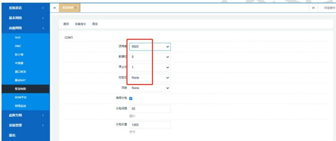
步骤 3: 找到“连接配置”，首先配置下行设备 UART\_DEV 为 modbus RTU 主站工作模式，从站 ID 为 1，分别如下：
