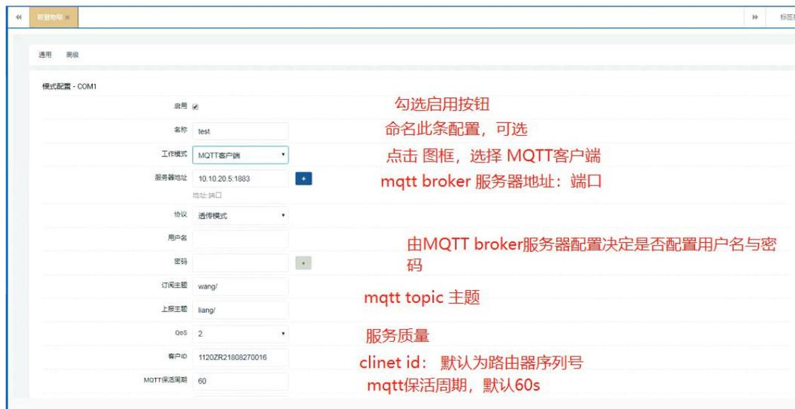
配置正确，保存后显示连接服务器成功。
