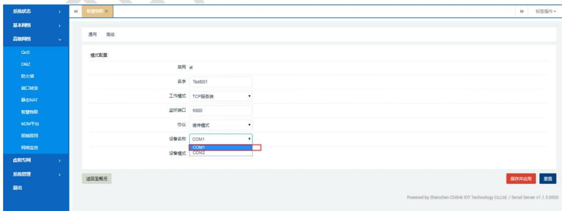
**注意:** 串口服务器有两个物理 COM 接口，与串口配置界面上的 COM1、COM2 一一对应。
