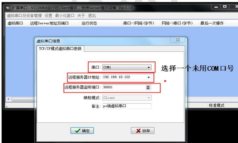
连接建立成功如下: 此步实际是 PC 将 虚拟 COM1 数据以 TCP/IP 数据流方式转到串口服务器上, 串口服务器透明传输到实际物理 COM 口上。
