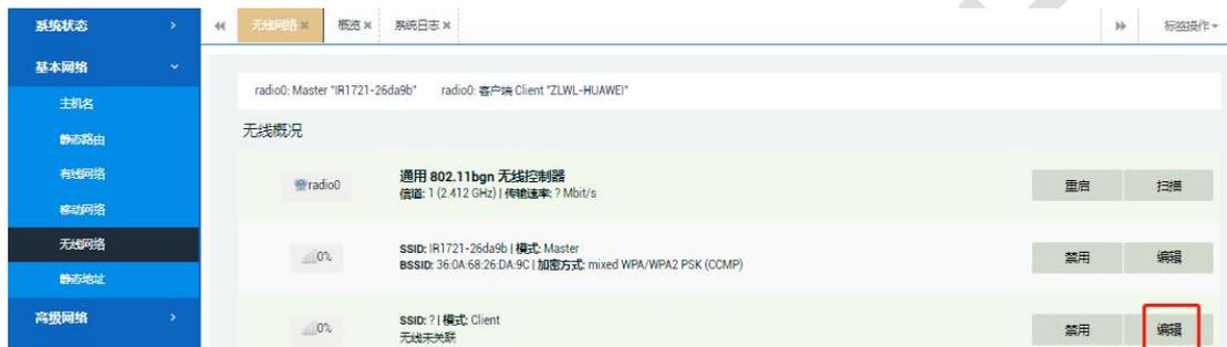
当页面跳转到 WIFI 接口配置页面，在“接口配置”---“基本设置”，选择“协议”为“静态地址”，然后输入 IP 地址、子网掩码、网关、DNS 服务器后保存应用即可。
