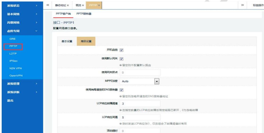
**【开机启动】**：勾选后，路由每次重启后会自动启动和连接 PPTP 服务；
