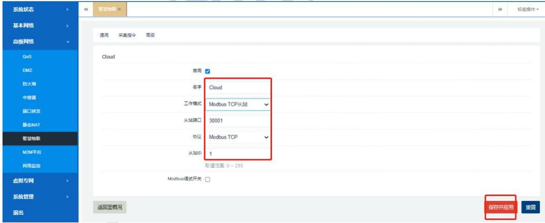
步骤 4：“模式配置”选项上下行默认配置即可，一般无需修改（注意：上下行设备名称必须和“连接配置”里面一致）。以上所有参数设置完如下图：
