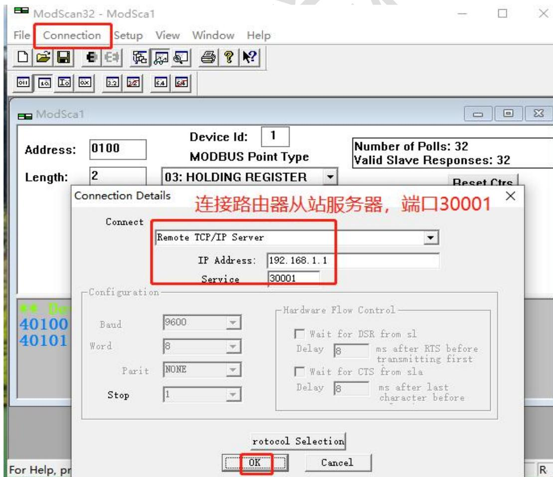
最终实现电脑端 Modbus TCP 主站和用户网口设备 Modbus TCP 从站模拟通讯，如下：
