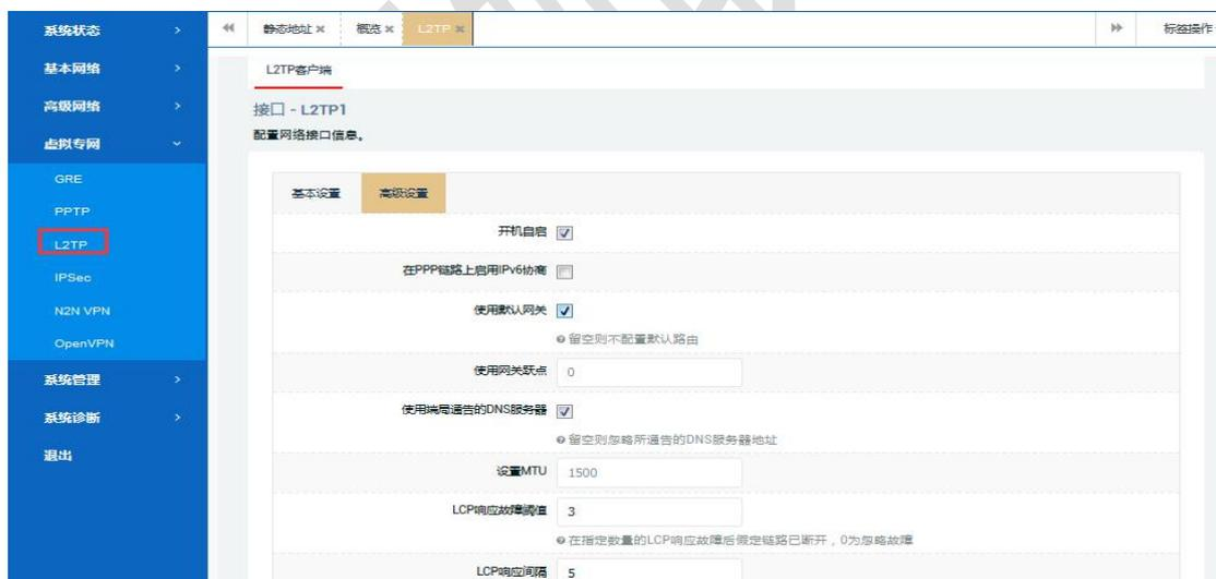
【开机启动】：勾选后，路由每次重启后会自动启动和连接 PPTP 服务；
