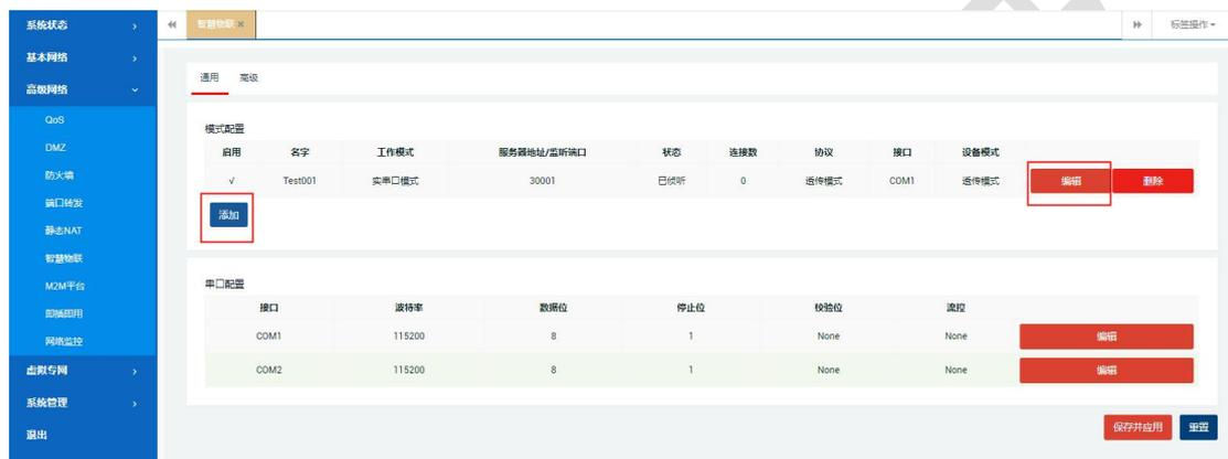
配置 启用勾选、名字（可为空）、工作模式选择：实串口模式、设备名称：COM1(根据现场实际使用)
