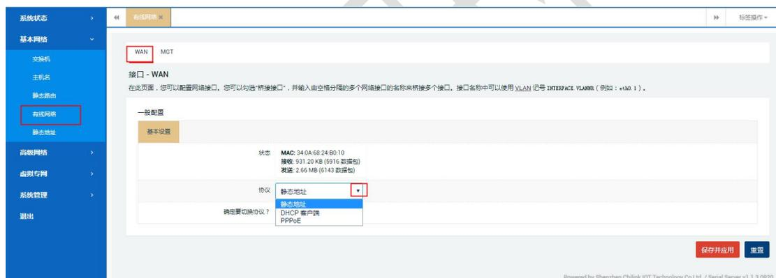
配置 IPV4 地址、子网掩码、IPV4 网关, 点击右下角 保存并应用
